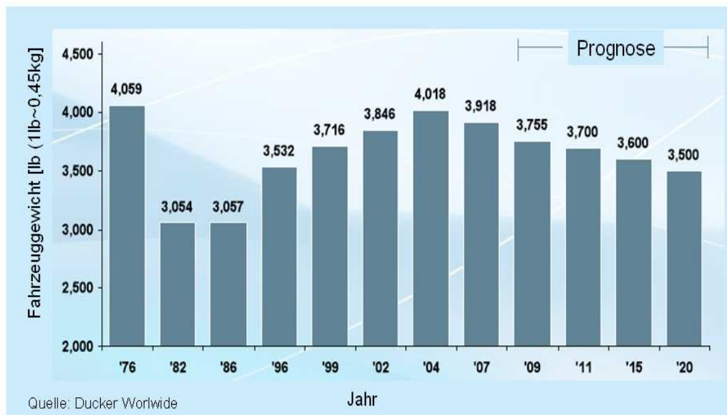
Abb. 2: Entwicklung der Fahrzeuggewichte (am Beispiel USA)
